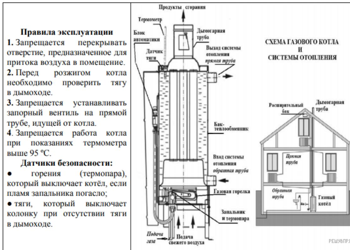
Почему, если гаснет запальник, то автоматически прекращается работа газового котла?
