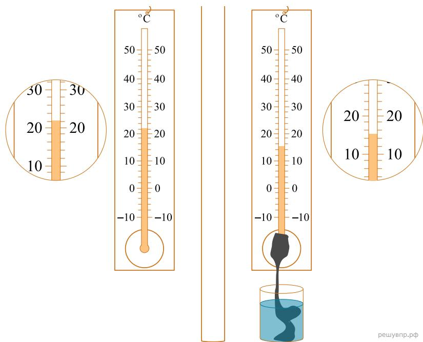
Запишите в ответе показания сухого термометра с учётом погрешности измерений. В ответе укажите значение и погрешность измерения слитно без пробела. Ответ приведите в  $^{\circ}\text{C}$ .
